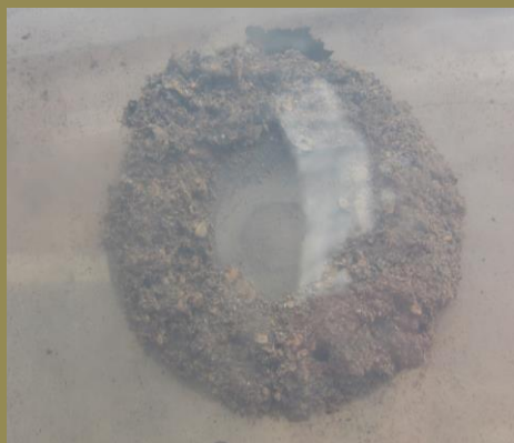
Sedimentin sisältämä järviolmi pelkistyi unissa ja erottui magneetilla muusta pohjatuhkasta
