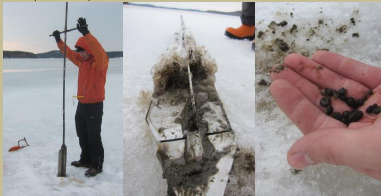
Kuvat 1-3. Haulimaisen järvimalmin nosto polttokoetta varten
